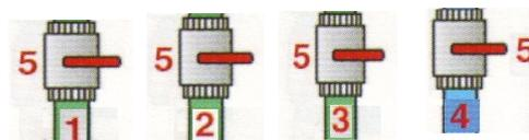
Allentare la ghiera superiore del motore in modo da permettere la perdita d'aria
